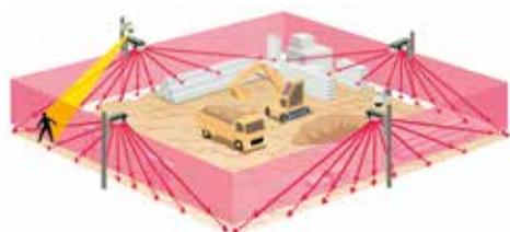
Figure d'une zone de détection horizontale
