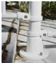
Pour une installation sur un sol bétonné ou dallé: platine en aluminium, plastifiée blanche, diamètre 48 mm + vis en inox M8 x 15 mm.
